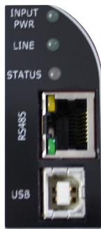
Modbus RTU (RS 485)
